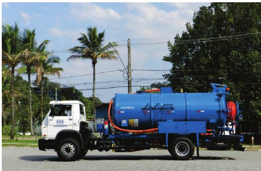
Novo caminhão equipado com hidrojateamento e esgotamento já está em uso
